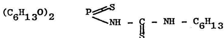
Dans un ballon tricol de 250 ml, on charge 48,5 g (soit 0,15 mole) d'O,O dihexylisothiocyanothiophosphate, puis on coule goutte à goutte pendant 30 mn 17 g (soit 0,165 mole) d'hexylamine. On maintient pendant 45 mn la température de 24-25°C. On obtient un milieu homogène coloré.
