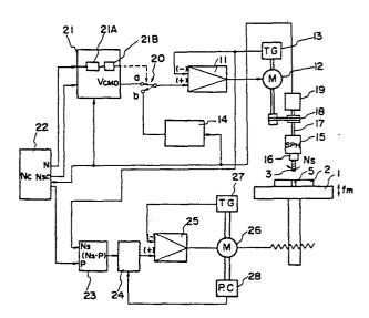
CONTROL SYSTEM FOR SYNCHRONISING MACHINE TOOL MOTORS FOR TAPPING OPERATIONS.
