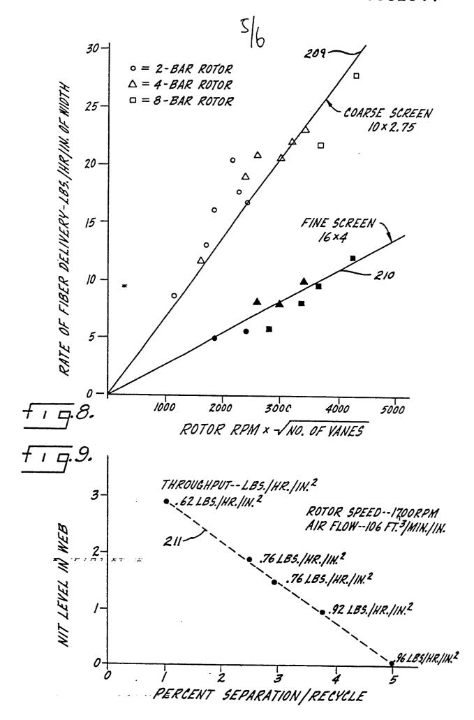
DRY FORMER FIBER DELIVERY RATES VS SCREEN OPENING
