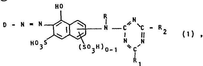
worin D der Rest einer aromatischen Diazokomponente, der weitersubstituiert sein kann und selbst eine Azobrücke enthalten kann, und der eine Halogen-s-triazinylaminogruppe enthält, und R Wasserstoff oder Alkyl mit 1 bis 4 Kohlenstoffatomen ist, und R<sub>1</sub> und R<sub>2</sub> unabhängig voneinander nichtreaktive Substituenten sind, und deren Herstellung.
