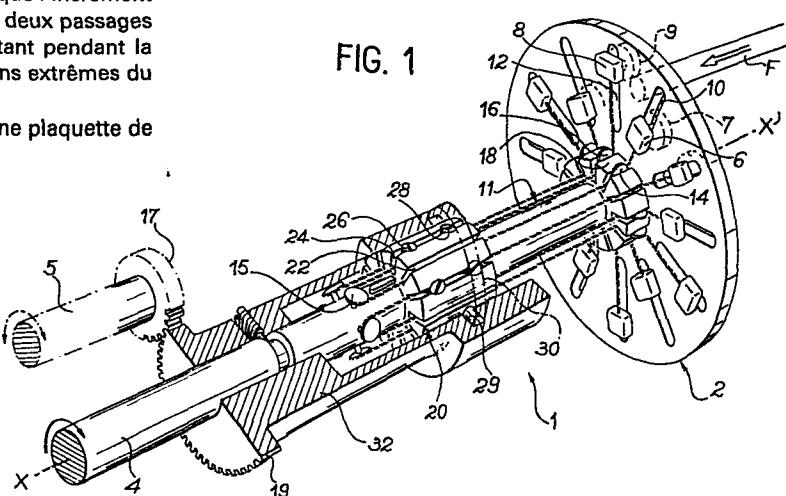
La présente invention a pour objet un porte-cibles à balayage mécanique permettant un dépôt ou une implantation homogène sur une ou plusieurs cibles montées sur le dispositif, ce dépôt ou cette implantation étant obtenu à l'aide d'une source d'énergie.
