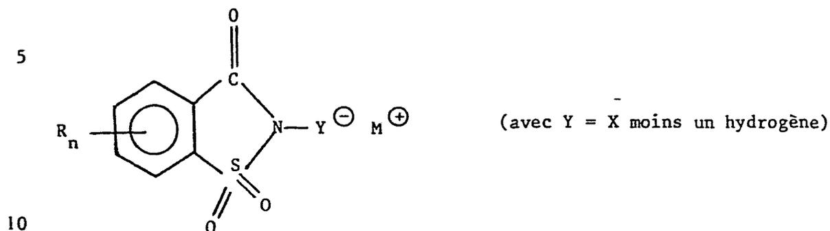
Ces sels sont obtenus par réaction directe du dérivé de la saccharine avec un sel métallique adéquat, ainsi, par exemple, les sels des métaux suivants : Cu, Cd, Co, Fe (II), Ni, Mn, Zn.
