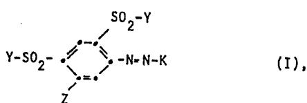
worin Y ein Rest  $-\text{CH}=\text{CH}_2$  oder  $-\text{CH}_2\text{CH}_2-\text{X}$ , X eine Abgangsgruppe, Z Wasserstoff, Halogen, C<sub>1-4</sub>-Alkyl, C<sub>1-4</sub>-Alkoxy oder Carboxy, und K der Rest einer bei einem pH-Wert  $\leq 7$  kuppelnden Kupplungskomponente ist, deren Herstellung und deren Verwendung zum Färben und Bedrucken von textilen Fasermaterialien.
