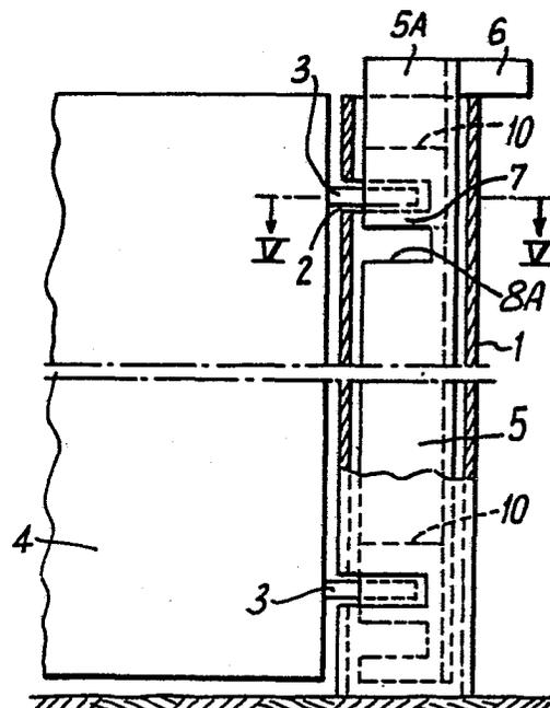
Dispositif de verrouillage d'un panneau mobile de fermeture et panneau muni de ce dispositif.
