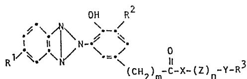
worin R<sup>1</sup>, R<sup>2</sup>, R<sup>3</sup>, X, Y, Z, m und n die in den Patentansprüchen angegebene Bedeutung haben eignen sich als copolymerisierbare UV-Stabilisatoren für aus ethylenisch ungesättigte Monomeren erhältliche Polymere. Die Verbindungen der Formel I sind leicht zugänglich und besonders wegen ihrer guten Löslichkeit im copolymerisierbaren Monomeren als UV-Absorber besonders wertvoll.
