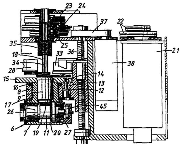
Querschlitten für eine Drehmaschine
