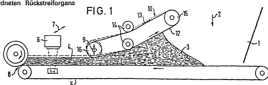
Die Erfindung betrifft ein Verfahren zur Erzielung einer vorgebaren Flächengewichtsverteilung in Querrichtung eines auf einem ebenen Dosierförderband mittels Rückstreiforganen zu formenden Vorvlieses aus mit mindestens einem Bindemittel versetzten lignozellulose- und/oder zellulosehaltigen Teilchen wie Spänen, Fasern oder dergleichen für die Herstellung von Span-, Faser- und dergleichen Platten. Ferner ist die Erfindung auf eine Vorrichtung zur Durchführung eines solchen Verfahrens gerichtet.
