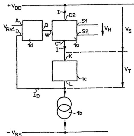
Verfahren und Schaltung zur Temperaturkompensation eines stromge-
