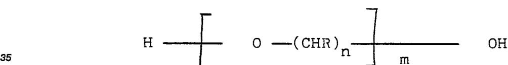
in der R = Wasserstoff oder ein niedriger Alkylrest, ggf. mit verschiedenen Substituenten, ist, n = 2-6 und m = 3-50 oder noch höher ist. Beispiele sind Poly(oxytetramethylen)glykole und Poly(oxyethylen)glykole.
