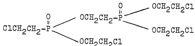
oder eines Gemisches der beiden Ester mit Thionylchlorid bei einer Temperatur von 60 bis 160 °C. Als Katalysatoren werden dabei tertiäre Phosphine, quaternäre Ammonium- oder Phosphoniumsalze oder Alkalihalogenide eingesetzt. Das Thionylchlorid wird in den vorgelegten Ester eingeleitet.
