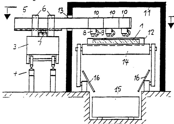
**Bandguß-Brennschneidmaschine in Stranggießanlagen**
