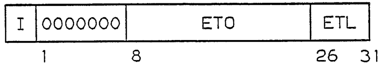
FIG. 7 LINKAGE-TABLE ENTRY (LTE)
