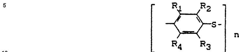
wobei  $R_1$  bis  $R_4$  unabhängig oder gleich sein können und  $C_1$ - $C_6$ -Alkyl, Phenyl oder Wasserstoff sind. Weiterhin können die Polyarylsulfide auch Diphenyl-Einheiten enthalten.
