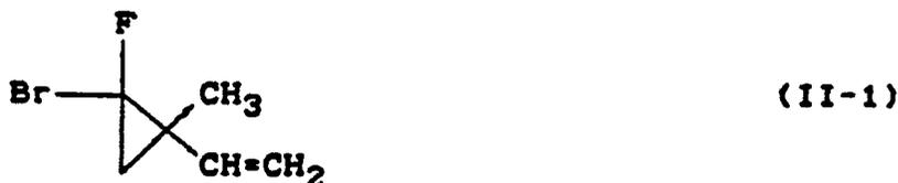
55 Zu einer intensiv gerührten Mischung aus 7,5 g (0,11 Mol) Isopren, 19 g (0,1 Mol) Fluor-dibrom-methan, 0,5 g (4 mMol) Tetrabutylammonium-bromid und 10 ml Dichlormethan werden 20 ml 50 %-ige wäßrige Natronlauge so zugetropft, daß das Reaktionsgemisch unter starkem Rückfluß siedet. Man rührt nach beendeter Zugabe noch fünf Stunden bei Raumtemperatur, gießt dann das Reaktionsgemisch auf Wasser, extrahiert mehrfach mit Diethylether und wäscht die vereinigten organischen Phasen nacheinander mit
