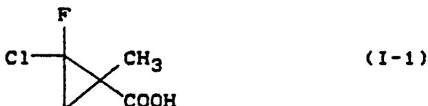
20 122,5 g (0,91 Mol) 2-Fluor-2-chlor-1-methyl-1-vinyl-cyclo-propan in 10 l Wasser werden portionsweise mit 474 g (3 Mol) Kaliumpermanganat versetzt. Man läßt 36 Stunden bei Raumtempertur rühren, filtriert von Braunstein ab und wäscht gut mit Wasser nach. Das Filtrat wird mit konzentrierter Salzsäure sauer gestellt und mit Dichlormethan extrahiert. Nach dem Trocknen der organischen Phase wird das Lösungsmittel unter
