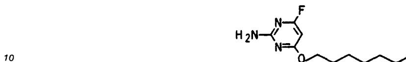
Zu einer Mischung von 5 g (0,038 mol) 2-Amino-4,6-difluorpyrimidin in 70 ml n-Heptanol gab man bei 20 bis 25 °C innerhalb 5 Minuten unter Rühren eine Lösung von 1,14 g (0,038 mol) 80 %iges Natriumhydrid (Suspension in Leinöl) in 30 ml n-Heptanol. Nach 2,5 Stunden wurde analog Beispiel 6 aufgearbeitet. Man erhielt so 6,3 g (73 % d.Th.) der Titelverbindung vom Fp. 30-32 °C.
