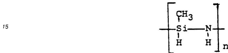
20 (Formel I mit  $a=1$ ,  $b=c=d=0$ ,  $R^1 = \text{CH}_3$ ,  $R^2 = \text{H}$ ) und dem Chlorsilan  $(\text{CH}_3)\text{HSiCl}_2$  im molaren Verhältnis 1:0.7 hergestellt worden.
