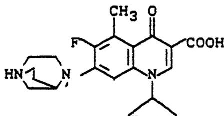
0,28 g (1 mmol) 1-Cyclopropyl-6,7-difluor-1,4-dihydro-5-methyl-4-oxo-3-chinolincarbonsäure werden in 3,5 ml Dimethylsulfoxid mit 0,17 g (1,5 mmol) 1,4-Diazabicyclo[3,2,1]octan und 0,34 g (3 mmol) 1,4-Diazabicyclo[2,2,2]octan 2 Stunden auf 140° erhitzt. Nach Entfernen des Lösungsmittels im Hochvakuum, wird der Rückstand mit Acetonitril verrührt und der Feststoff isoliert.
