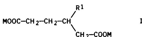
in der R<sup>1</sup> eine geradkettigen oder verzweigten C<sub>8</sub>-C<sub>30</sub>-Alkyl- oder -Alkenylrest bezeichnen und M für Alkalimetall oder Alkanolammonium steht.
