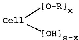
wiedergegebene Struktur aufweist, worin Cell das Gerüst des unmodifizierten Cellulosemoleküls oder des Chitinmoleküls jeweils ohne Hydroxylgruppen ist, s beim unmodifizierten Cellulosemolekül 3 und beim Chitinmolekül 2 beträgt und x dem Veretherungsgrad entspricht, der im Bereich von 0,08 bis (s-0,4) liegt.
