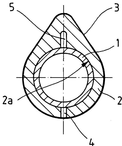
Die Erfindung betrifft eine Hohlwelle mit durch hydraulisches Aufweiten befestigten Teilen, insbesondere eine Nockenwelle.
