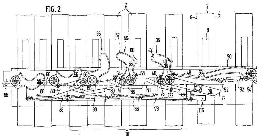
Die Erfindung betrifft eine Verschiebevorrichtung für Filterplatten an einer Filterpresse nach dem Oberbegriff des Anspruchs 1.
