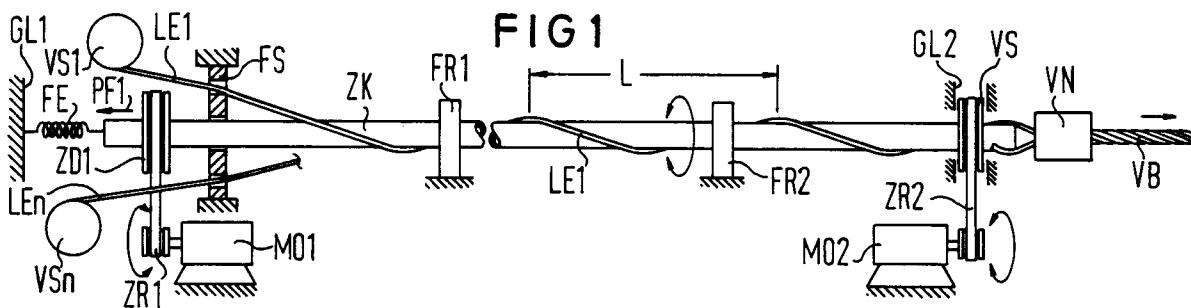
Die Erfindung betrifft ein Verfahren zur Verseilung von elektrischen und/oder optischen Leitern mit wechselnder Schlagrichtung (SZ-Verseilung) unter Verwendung eines langgestreckten mit wechselnder Drehrichtung betriebenen zylindrischen Körpers, der von den Leitern umschlungen wird, die endseitig einer Verseilscheibe zugeführt werden.
