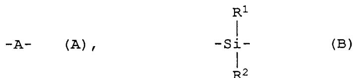
worin  $R^1$  und/oder  $R^2$  für Wasserstoff, Alkyl, Cycloalkyl oder Phenyl stehen und A für einen Alkylenrest mit 1 bis 6 C-Atomen steht, wobei die Struktureinheiten der Formeln (A) und (B) im Verhältnis von etwa 1:1 im Polycarbosilan vorliegen.
