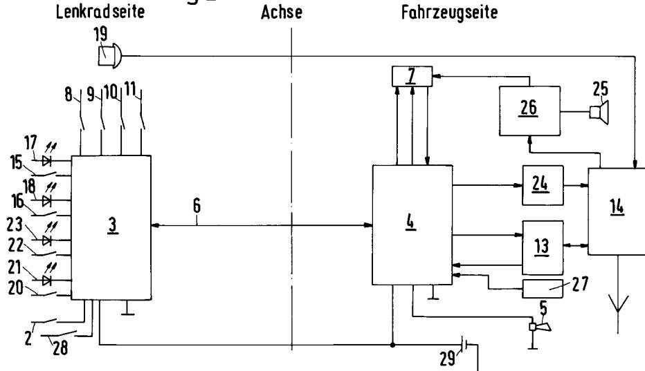
Die Erfindung betrifft eine Vorrichtung zur Übertragung von elektrischem Strom und Daten in bidirektioneller Flußrichtung zwischen der Lenkrad- und der Fahrzeugseite eines Kraftfahrzeugs mittels eines elektromechanischen Drehübertragers und mehrerer im Lenkrad integrierter Tastschalter mit ggf. zugeordneten Leuchtdioden.
