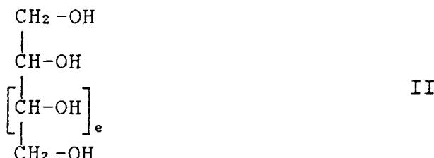
mit Alkylenoxiden in Gegenwart eines basischen Katalysators bei Temperaturen von 120 – 180 °C unter einem Druck von maximal 4 bar zu Verbindungen der allgemeinen Formel (III)
