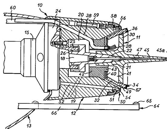
L'invention concerne un dispositif de projection électrostatique de produit de revêtement liquide tel qu'une peinture, du type muni d'une tête de pulvérisation rotative comprenant une partie approximativement en forme de bol présentant un bord de pulvérisation annulaire où le produit de revêtement est pulvérisé sous l'effet de la force centrifuge.
