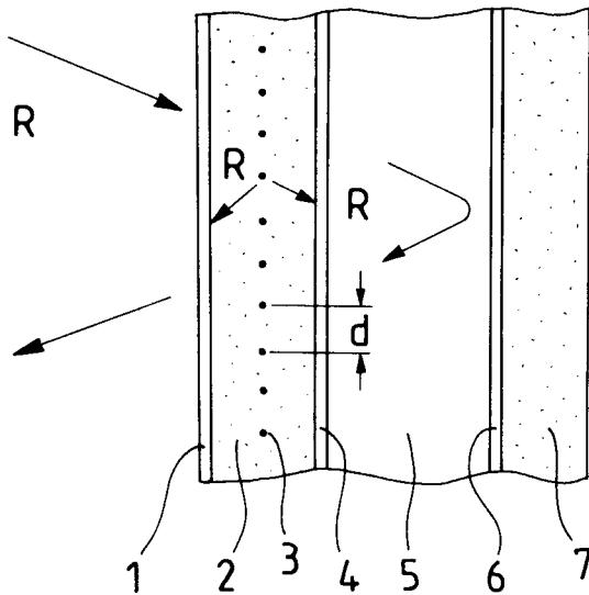
Die Erfindung betrifft eine Fensterverglasung, bestehend aus einer Doppelverglasung mit abgedichtetem Zwischenraum, bei der im Bereich der Außenscheibe eine lichtdurchlässige Schicht (3) mit definiertem Oberflächenwiderstand angeordnet ist und bei der die Innenscheibe mit einer radarreflektierenden, optisch transparenten Schicht (6) versehen ist.
