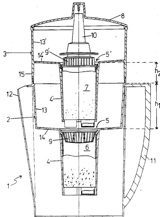
Die vorliegende Erfindung betrifft eine Vorrichtung zum mindestens teilweisen Entsalzen von Trinkwasser im Haushalt, insbesondere für die Nahrungsmittelzubereitung. Bei bekannten Filterverfahren dieser Art läßt man Wasser durch ein Filterbett fließen, das an mindestens ein Trägermaterial gebundenes Ionenaustauschermaterial enthält.
