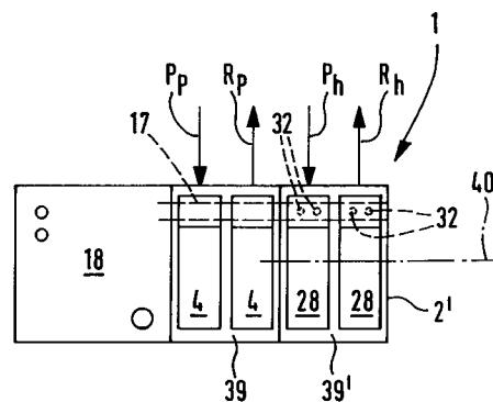
Die Erfindung betrifft eine Ventilstation zur Verwendung im Zusammenhang mit der Steuerung fluidbetätigbarer Einrichtungen, beispielsweise von Arbeitszylindern, mit einem über interne Fluidkanäle verfügenden Fluidverteiler, der mit elektrisch betätigbaren Pneumatikventilen bestückt ist, die mit den Fluidkanälen kommunizieren, und mit einem Signalverteiler, von dem aus die Pneumatikventile ihre elektrischen Betätigungssignale erhalten.
