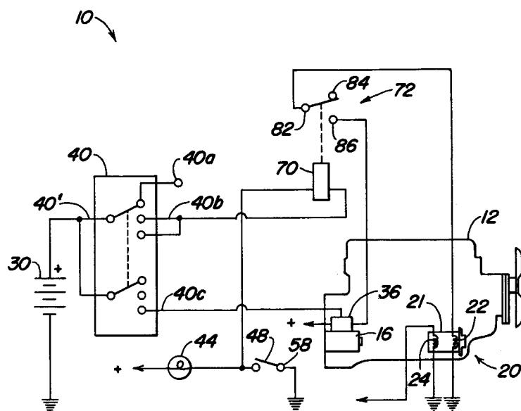
Die Erfindung bezieht sich auf einen Startschalterstromkreis für einen Motor mit einem an eine Stromquelle angeschlossenen Startschalter, einem Zustandsschalter, der bei Erreichen einer bestimmten Bedingung anspricht, und mit einer elektrischen Betätigungs vorrichtung, die während des Startvorgangs für eine Kraftstoffzufuhr aktivierbar ist.
