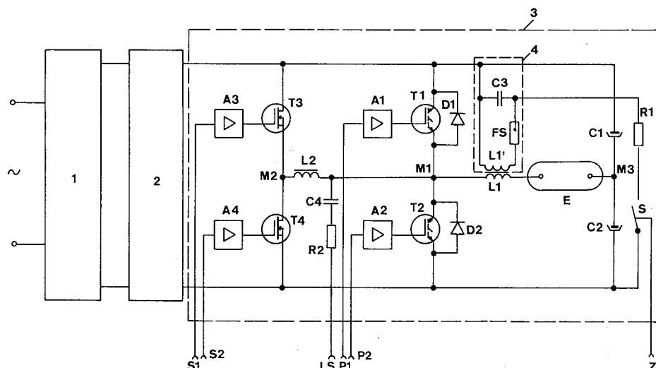
Die Erfinung betrifft eine Schaltungsanordnung zum gepulsten Betrieb einer Entladungslampe, insbesondere einer Natriumhochdruckentladungslampe, gemäß dem Oberbegriff des Anspruchs 1.
