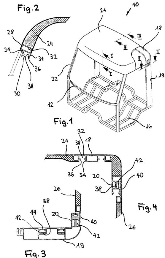
Die Erfindung betrifft eine Kabine für Fahrzeuge und Gerätschaften, mit einer aus einzelnen Strukturbauteilen zusammengesetzten Aufbaustruktur.
