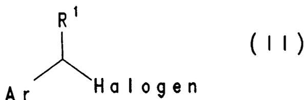
worin Ar und R<sup>1</sup> die oben angeführten Bedeutung besitzen und Halogen für I, Br, Cl steht, mit einem wasserlöslichen Metallkomplex als Katalysator in einem Zweiphasensystem carbonyliert werden.
