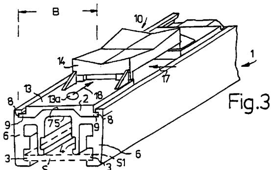
a) an der Plattenrückseite (7) auf Abstand (B) parallel zueinander verlaufende Adapternuten (8) vorgesehen sind, die der Aufnahme von Schienenrändern (9) eines Adapters (10) dienen;
