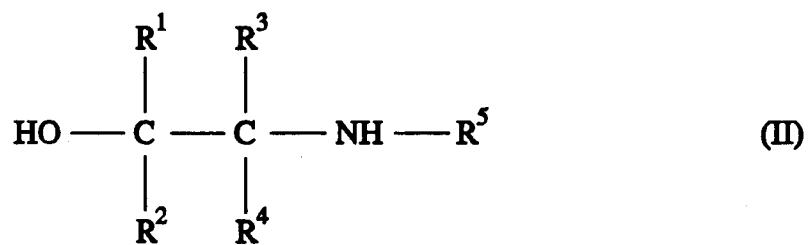
in der die Substituenten R<sup>1</sup>, R<sup>2</sup>, R<sup>3</sup>, R<sup>4</sup> und R<sup>5</sup> die oben genannten Bedeutung haben, in der Gasphase bei Temperaturen von 200 bis 600°C und einem Druck von 0,001 bis 5bar an Heterogenkatalysatoren, indem man als Heterogenkatalysatoren vorgesinterte Formteile mit einheitlicher Porengröße im Makroporenbereich einsetzt.
