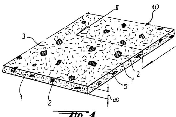
besteht, wobei die mit Kunstharmörtel-Schicht(-en) versehene Dämmplatte derart elastisch verformbar ist, daß diese beim Andrücken auftretende Unebenheiten der zu bedekkenden Oberfläche ausgleicht, und daß diese zu einer Rolle (200) aufwickelbar ist.
