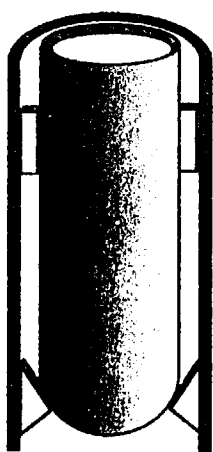
Abbildung 4: Verdampfungszelle mit ein- gesetztem Tiegel (Schnitt)
