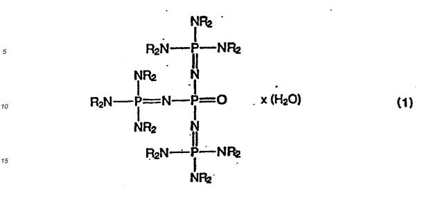
dans laquelle les R sont identiques ou différents et représentent chacun un radical hydrocarboné comportant de 1 à 10 atomes de carbone, et x se situe dans une plage de 0 à 5,0, ou en présence dudit composé d'oxyde de phosphine et d'un composé à hydrogène actif choisi parmi l'eau ou un
