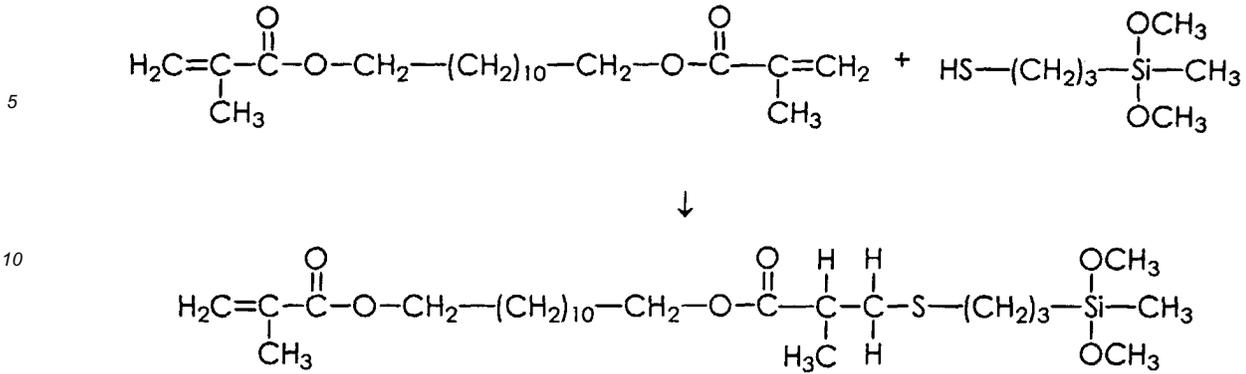
15 **[0072]** Anschließend wird das resultierende Silan hydrolytisch polykondensiert, und die daraus gefertigte Membran wird durch Polymerisation der Methacrylat-Gruppen gehärtet.
