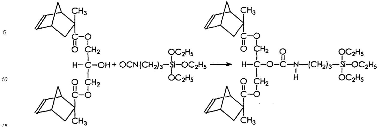
und anschließend mit dem Dimethyldiethoxysilan hydrolytisch polykondensiert. Das resultierende Polykondensat wird mit Trimethylpropan-tris(3-mercaptopropionat versetzt und zu Membranen verarbeitet, deren Härtung dann durch strahlungsinduzierte Polyaddition des Trimethylpropan-tris(3-mercaptopropionat an die C=C-Doppelbindungen der Norbornen-Reste erfolgt.
