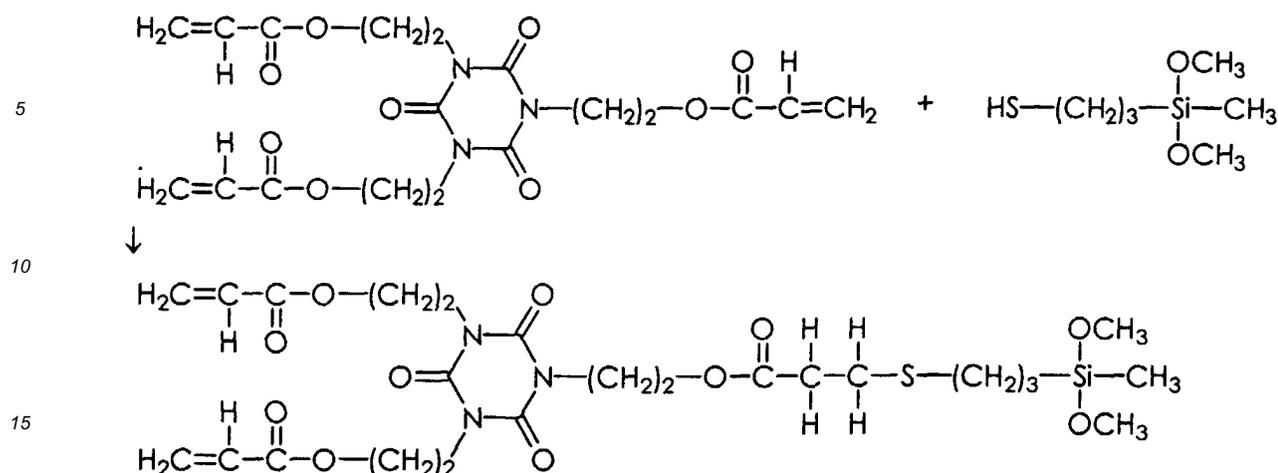
20 **[0063]** Anschließend wird zum Aufbau des anorganischen Netzwerkes das resultierende Silan zusammen mit dem Tetraethoxysilan hydrolytisch polykondensiert, und die daraus gefertigte Membran wird durch Polymerisation der Acrylat-Gruppen gehärtet.
