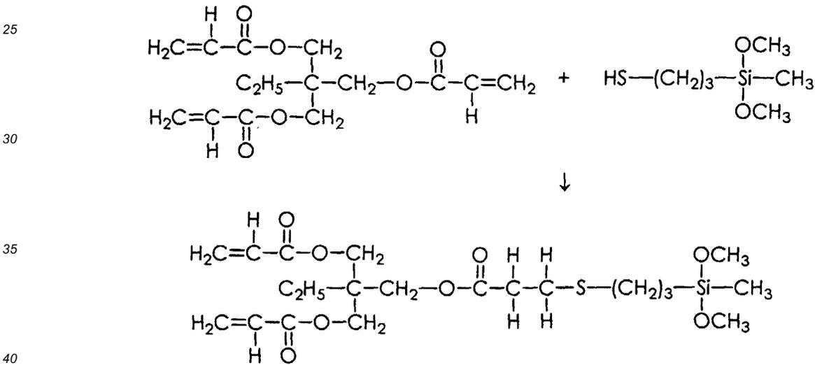
**[0061]** Das resultierende Silan wird zum Aufbau des anorganischen Netzwerkes hydrolytisch polykondensiert. Aus dem Polykondensat werden dann nach üblichen Verfahren Membranen gefertigt, bei deren Härtung durch Polymerisation der Acrylat-Gruppen das organische Netzwerke aufgebaut wird.
