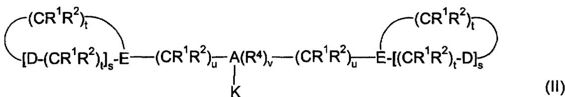
darstellt und die einzelnen Symbole die in der Beschreibung definierten Bedeutungen haben. Die Metallkomplexe eignen sich als Bleichkatalysatoren in Wasch-, Reinigungs- und Desinfektionsmitteln, die Peroxi-Verbindungen enthalten.
