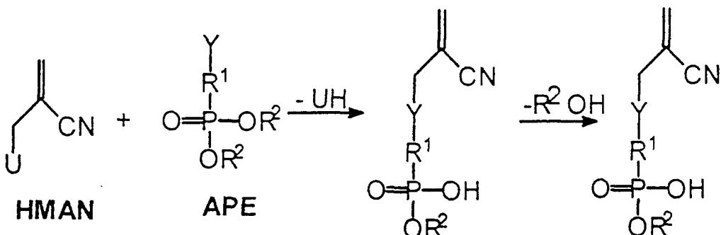
**[0021]** Konkret führt die Umsetzung von α-Chlormethylacrylnitril mit 2-Hydroxyethylphosphonsäuredimethylester über 2-[4-(Dimethoxyphosphoryl)-2-oxybutyl]-acrylnitril nach Silylierung mit Trimethylsilylbromid und Desilylierung mit Methanol zur entsprechenden Phosphonsäure {2-[4-(Dihydroxyphosphoryl)-2-oxabutyl]-acrylnitril}:
