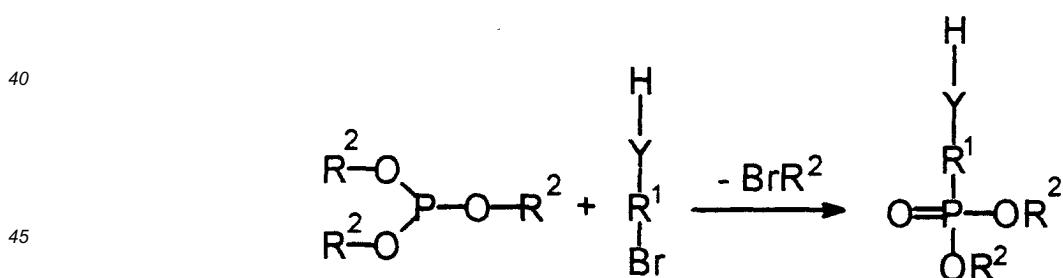
[0025] Konkret kommt es bei der Reaktion von Triethylphosphit mit 2-Bromethanol zur Bildung des 2-Hydroxyethylphosphonsäurediethylesters:
