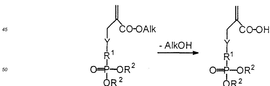
[0033] Konkret führt die Umsetzung von 2-[4-(Dimethoxyphosphoryl)-2-oxabutyl]-acrylsäureethylester mit Natriumhydroxid unter Abspaltung von Ethanol zu 2-[4-(Dimethoxyphosphoryl)-2-oxabutyl]-acrylsäure:
