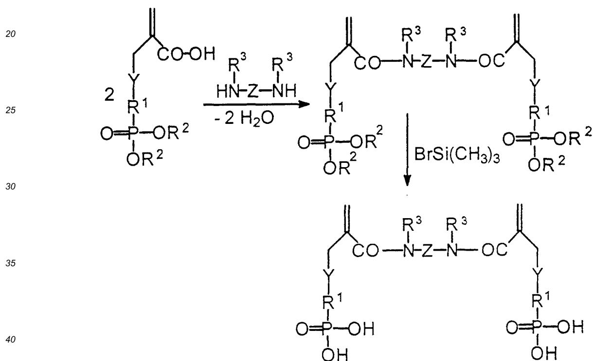
[0035] Beispielsweise ergibt die Umsetzung von 2-[4-(Dimethoxyphosphoryl)-2-oxa-butyl]-acrylsäure mit Ethylen-diamin das N,N'-Bis-[(6-dimethoxyphosphoryl)-4-oxa-2-methylen-hexanoyl]-ethylendiamin, das sich durch Behandlung mit Trimethylsilylbromid in das N,N'-Bis-[(6-dihydroxyphosphoryl)-4-oxa-2-methylen-hexanoyl]-ethylendiamin überführen lässt:
