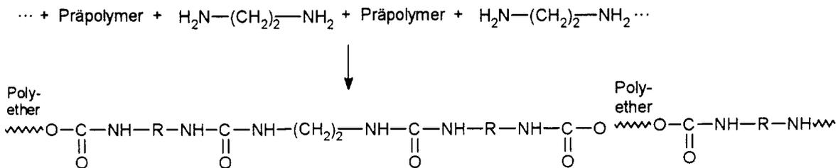
[0018] Die so erhaltenen thermoplastischen Elastomere werden anschließend durch Schmelz- od. Lösungsspinnen verarbeitet. In den resultierenden Spandex-Fasern wirken die "harten" Polyurethan-Segmente als physikalische Vernetzungsbereiche für die weiche Matrix aus Polyether-Segmenten. Spandex-Fasern weisen etwa die gleiche
