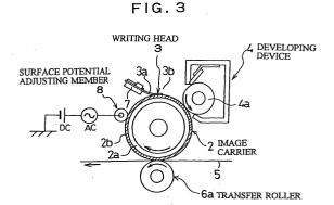
IN CASE OF SURFACE POTENTIAL ADJUSTING MEMBER OF ROLLER TYPE
