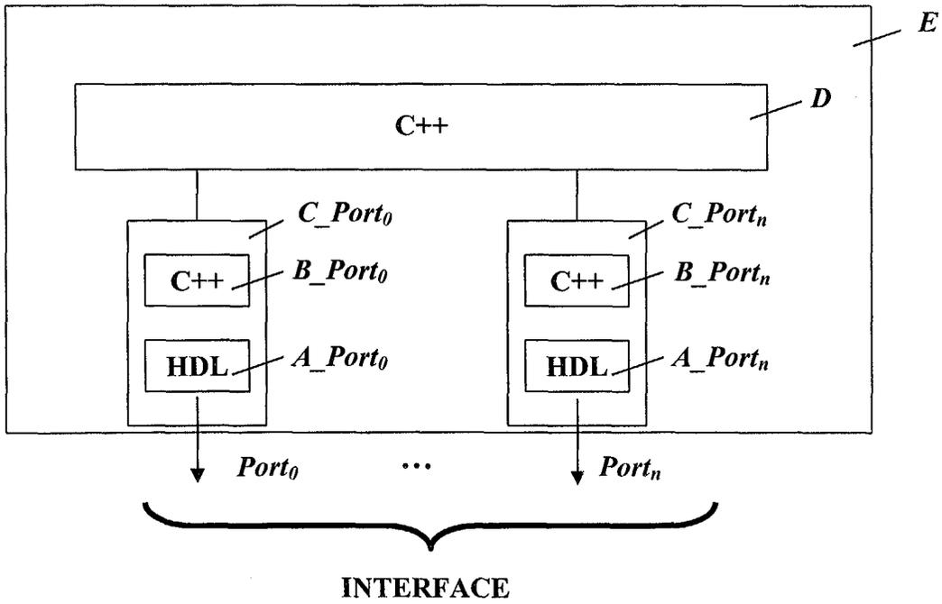
Figure 5 : Structure générique d'un Modèle Composé C++
