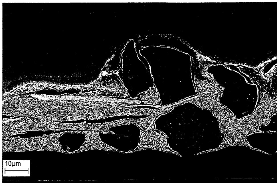
Abbildung 7: Rasterelektronenmikroskopische Aufnahme einer Nagellackapplikation enthaltend das Metalleffektpigment Visionaire Sparkling Silver Sea und das mikronisierte Wachs Ceraflour 914 (Beispiel 7)
