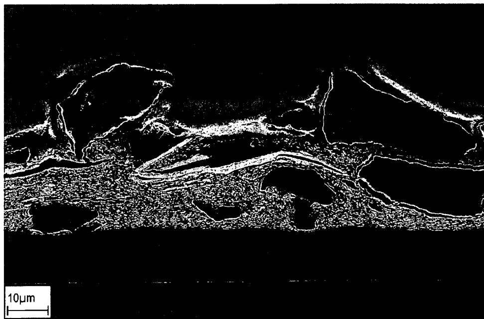
Abbildung 8: Rasterelektronenmikroskopische Aufnahme einer Nagellackapplikation enthaltend das Metalleffektpigment Visionaire Sparkling Silver Sea und das mikronisierte Wachs Ceraflour 914 (Beispiel 7)
