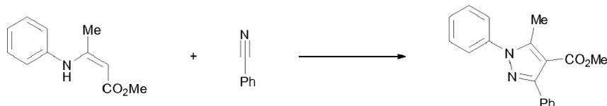
**[0036]** Dabei wurden folgende Reaktionsbedingungen eingestellt: 0.25 mmol Enamin-Edukt,  $\text{Cu}(\text{OAc})_2$  (10 Mol-%), PhCN (Anteil siehe Tabelle), Additiv, DCE (0.5 M), 110 °C, 24 h, unter einer  $\text{O}_2$  Atmosphäre (1 bar, geschlossenes Gefäß).
